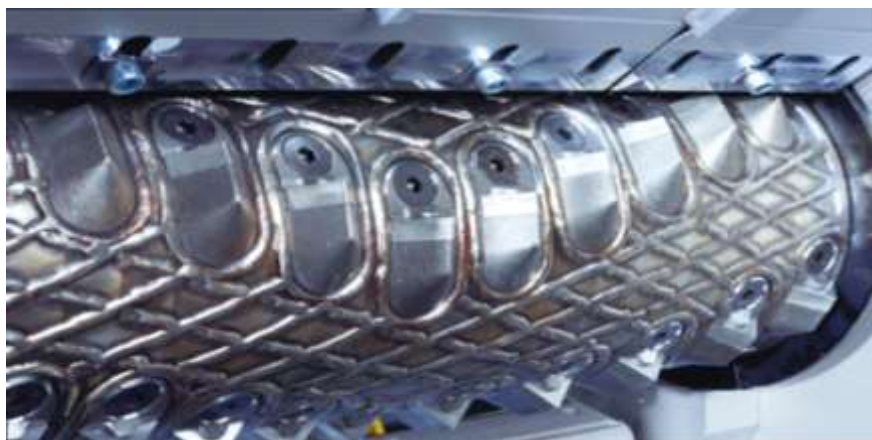
Obrázek č. 4 – Pohled na rotor s nožovými hroty
