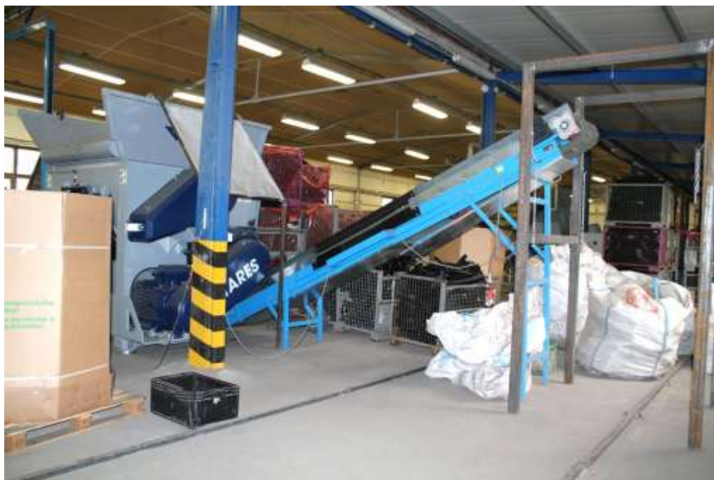
Obrázek č. 5 – Výrobní hala - drtič ANTARES s výstupním dopravníkem a konstrukcí pro uchycení big-bagů
