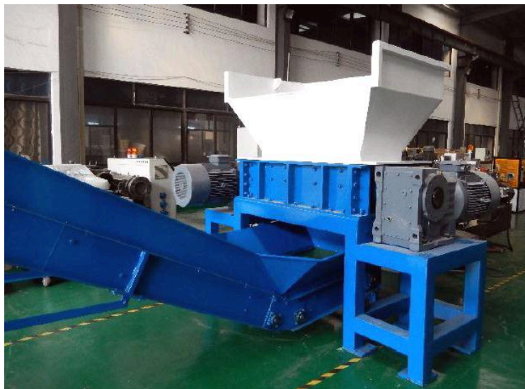
Obrázek č. 3 a 4 – Dvuhřídelový drtič GL 1200 a pohled na drticí mechanismus
