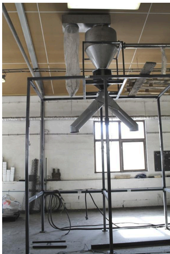
Obrázek č. 5 – Výstupní cyklon s hadicovým filtrem
